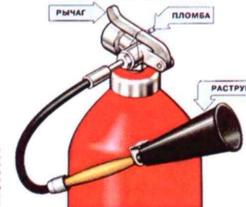
**ПРИНЦИП ДЕЙСТВИЯ** основан на вытеснении двуокиси углерода избыточным давлением. При открывании запорно-пускового устройства CO<sub>2</sub> по сифонной трубке поступает к раструбу и из сжатого состояния переходит в твердое (снегообразное). Температура резко (до -70 °С) понижается. Снегообразный заряд попадает на горящее вещество, вытесняет его от кислорода.
